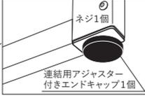
ネジ1個<br>連結用アジャスター付きエンドキャップ1個<br>連結用アジャスター付きエンドキャップ1個がネジで止められています<br>別梱包のアジャスターを組み付けてからご使用ください | 1 枚 | 2 個 |
