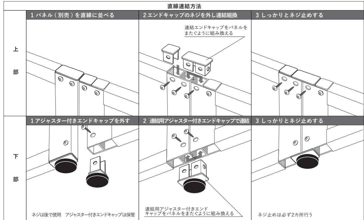
安定脚が必要な箇所 安定脚はパネル2枚を直線※に連結させたら1脚追加し、必ず安定を確保してください。※2枚目のパネルの端がL字型の場合は不要です。
